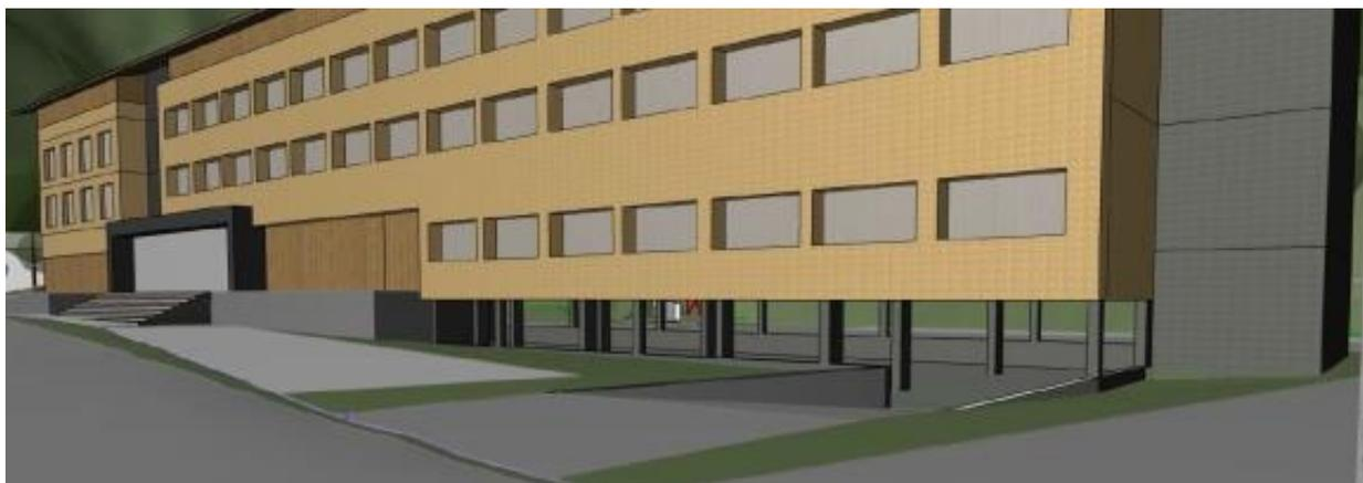
Abbildung 10: Erhöhung des Hotelgebäudes mit offenen, überdachten Parkplätzen (anstelle der Tiefgarage) zur Schaffung von Retentionsraum, Quelle: EDR GmbH „Hydraulische Untersuchung, Einschätzung zur Planungsänderung“, 13.10.2023
